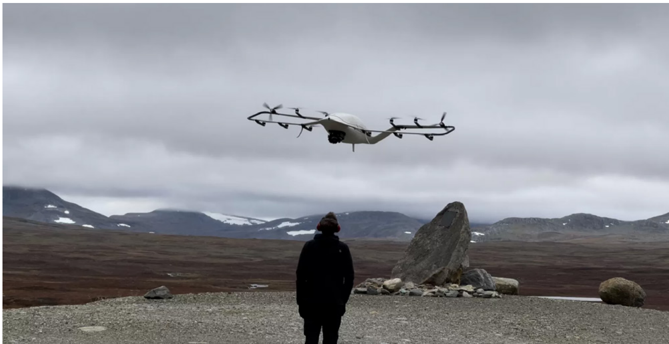
Bilden visar Katla3 med 3 meter vingspann. som kan lyfta 15 kg och som ska flyga i enlighet med EASA BVLOS regelverk. Bild: Katla Aero, katla.aero, 2026
